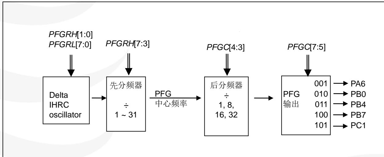
图 43: PFG 硬件电路的模块框图
