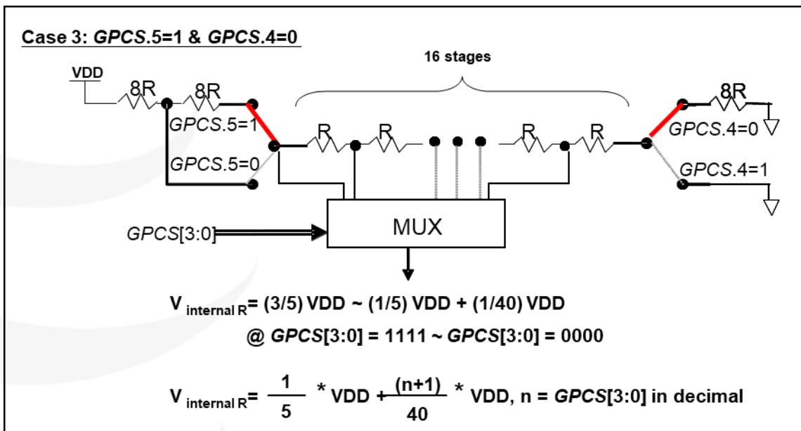
图 33:  $V_{internal\ R}$  硬件接法 ( $GPCS.5=1$  &  $GPCS.4=0$ )
