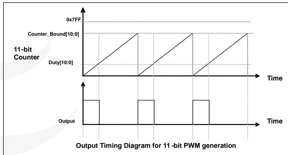
图 22: 11 位 PWM 生成器(PWMG0)的输出时序图
