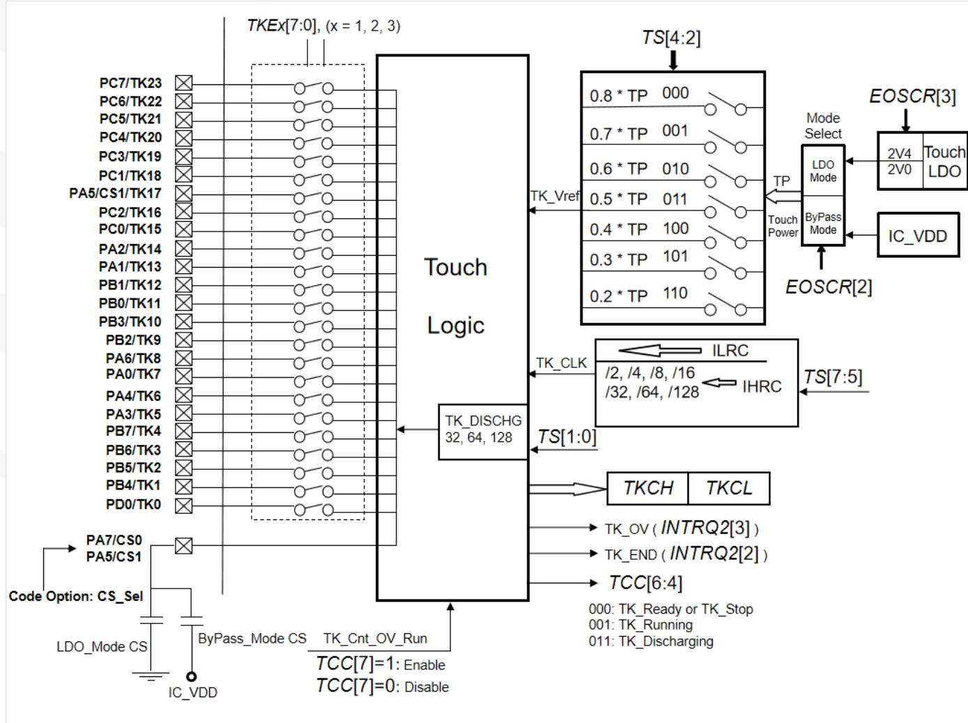
图 41：触摸检测电路的功能方框图
