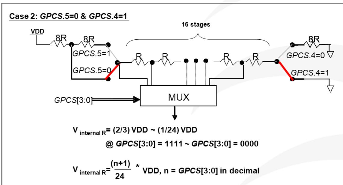
图 32:  $V_{internal\ R}$  硬件接法 ( $GPCS.5=0$  &  $GPCS.4=1$ )
