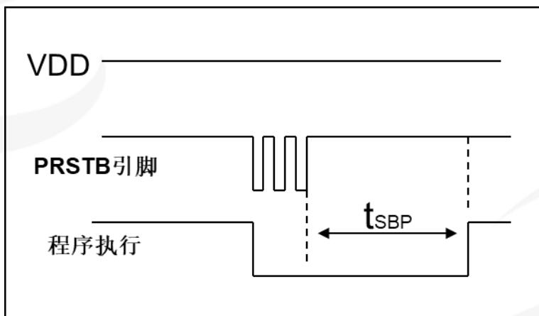
图 14：外部引脚复位的相关时序
