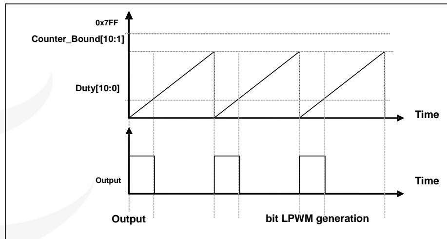
图 26: 11 位 LPWM 生成器输出时序图
