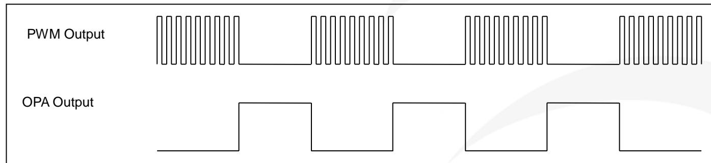
图 37: OPA 比较器模式控制 PWM 输出
