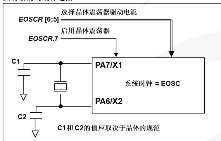
图 8: 外部晶体振荡器的硬件连接
