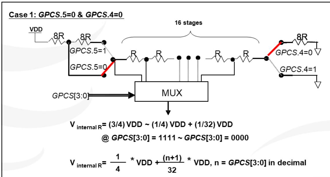
图 31:  $V_{internal\ R}$  硬件接法 ( $GPCS.5=0$  &  $GPCS.4=0$ )
