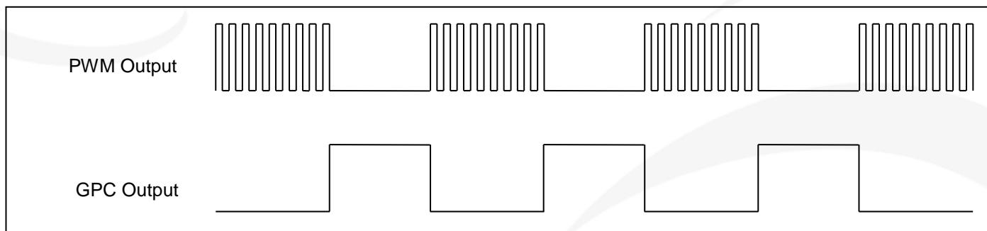
图 30: 比较器结果控制 PWM 输出
