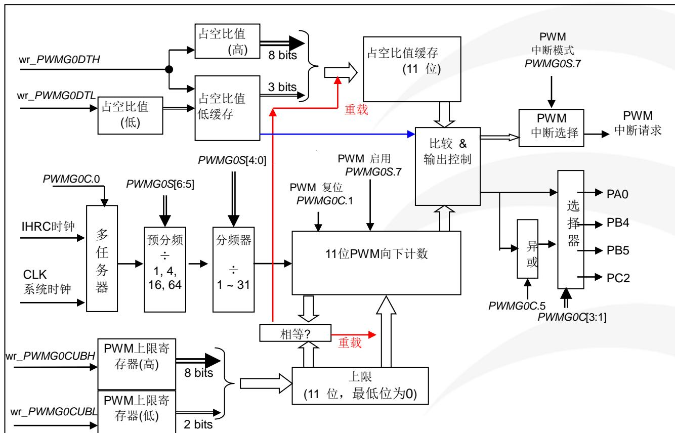
图 21: 11 位 PWM 生成器 (PWMG0) 硬件框图
