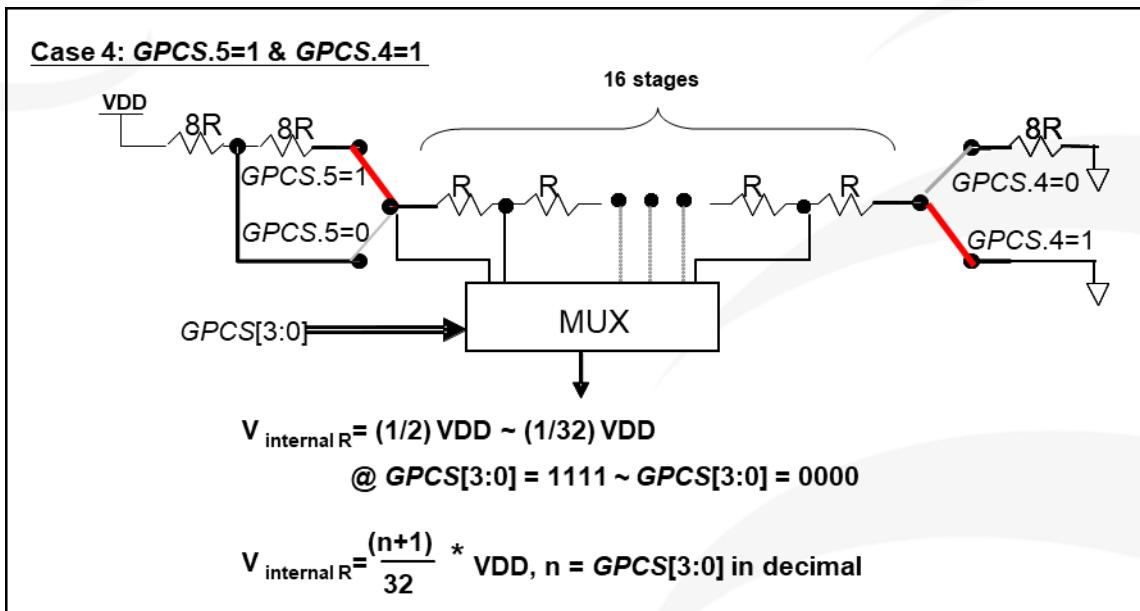
图 34:  $V_{internal\ R}$  硬件接法 ( $GPCS.5=1$  &  $GPCS.4=1$ )
