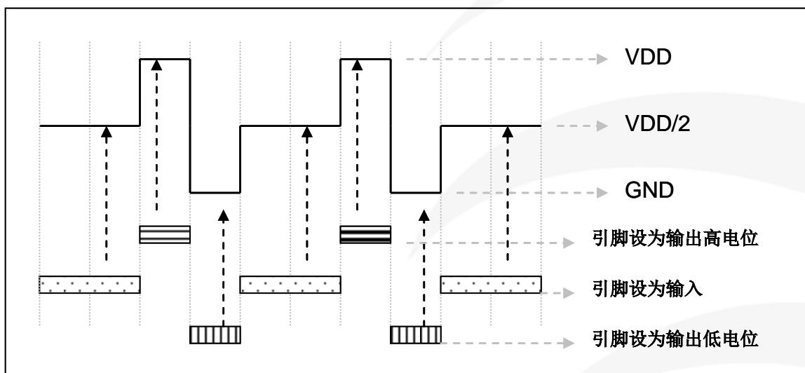
图 35: 使用 VDD/2 偏置电压产生器
