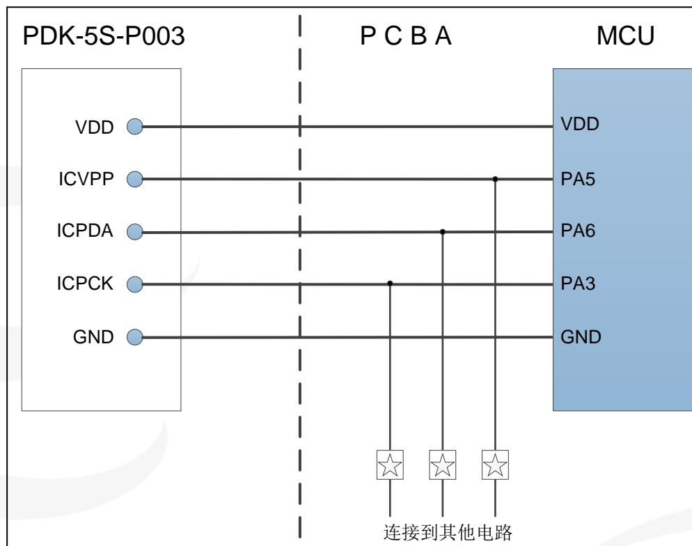
图 44: 在板烧录接线示意图
