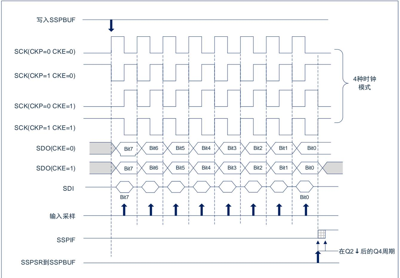
图 19-2: SPI 模式的波形 (主控模式)
