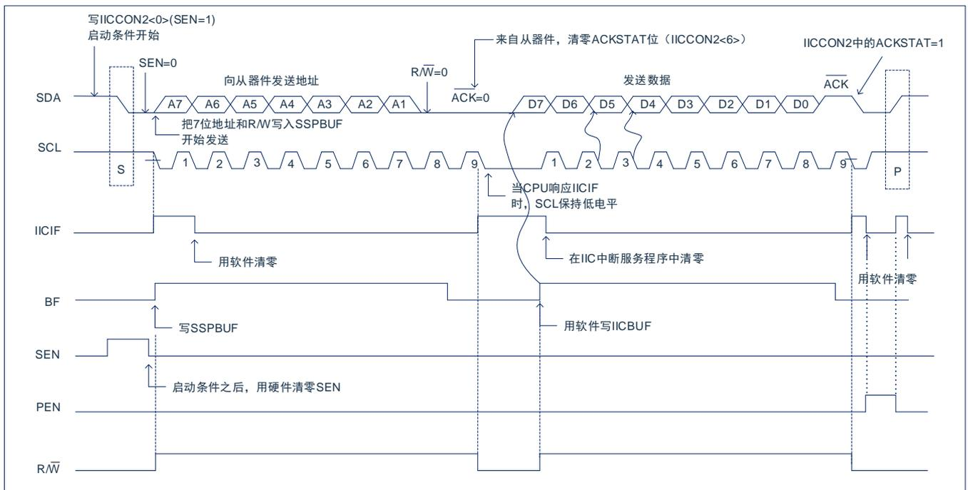
图20-5: I<sup>2</sup>C™主控模式发送时序
