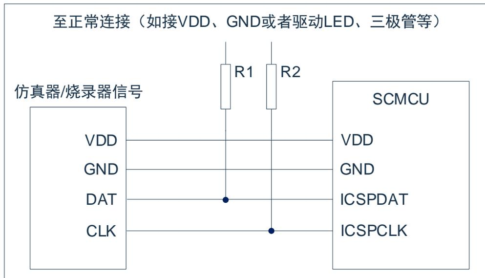
图 1-1：典型的在线串行编程连接方法
