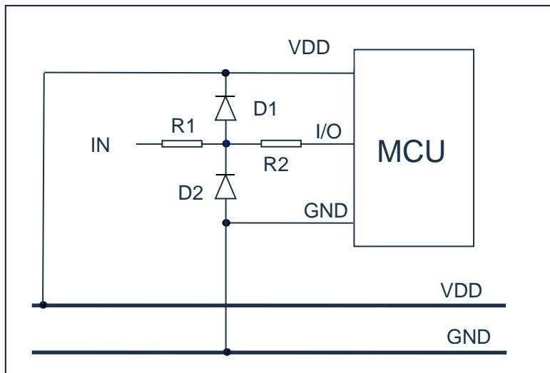
图 6-3: I/O 口注意事项连接图
