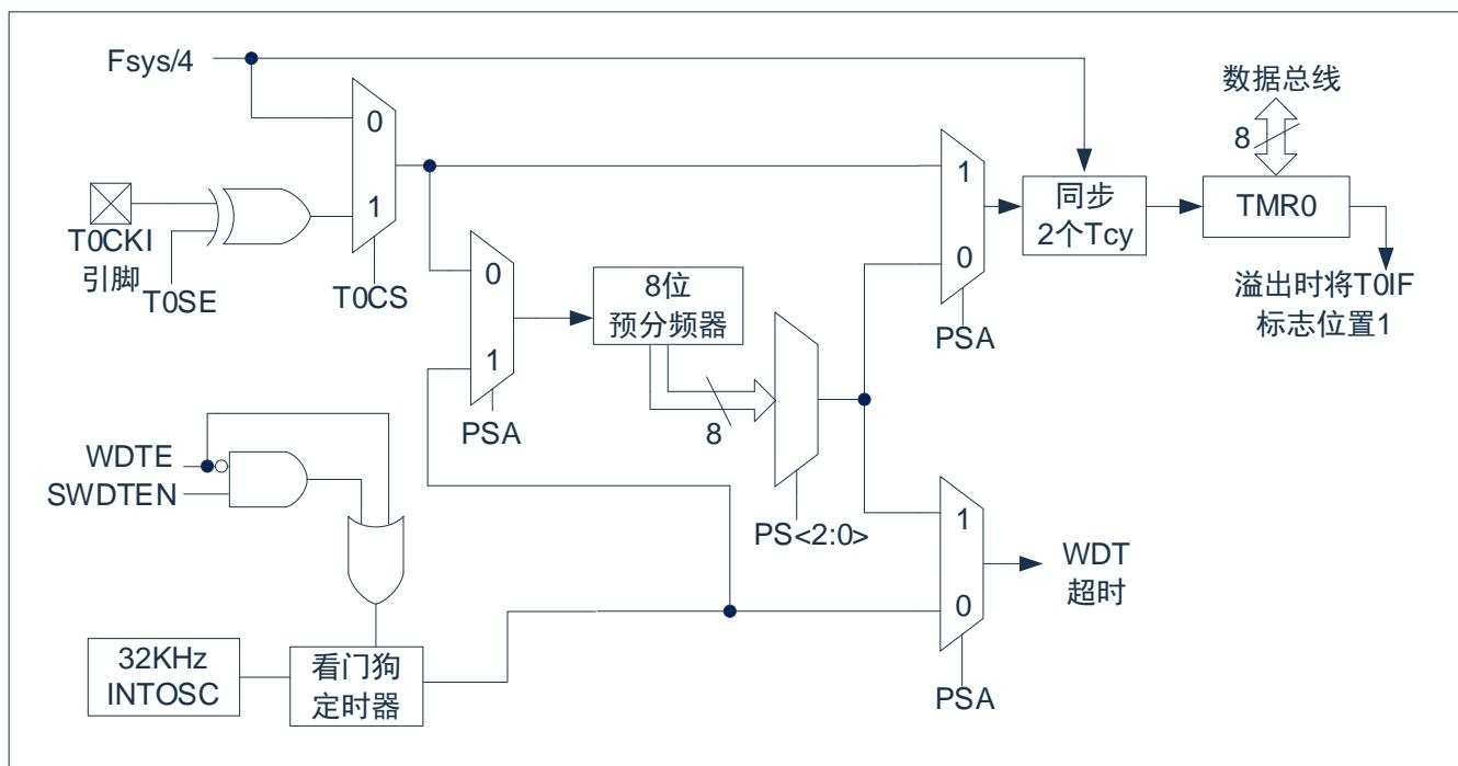
图 8-1：TIMER0/WDT 结构图
